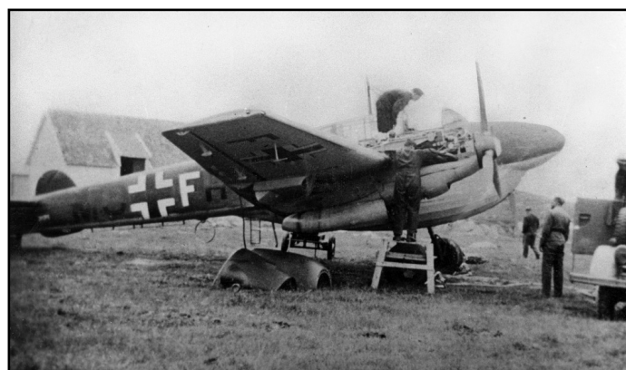
Bf 110 D „M8+FH“ z I./ZG 76 vybavený přidavnou nádrží „Dackelbauch“ pod trupem. Jednotka měla základnu v norském Stavangeru a 15. srpna 1940 zajist'ovala doprovod pro bombardéry Luftflotte 5 se základnami ve Skandinávii. V boji s RAF jednotka ztratila sedm osádek včetně velitele a jeho pobočníka. Fotografie: SDASM
